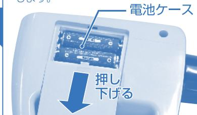
1. 乾電池ケースカバーを図の矢印の方向に押し下げながらはずします。
